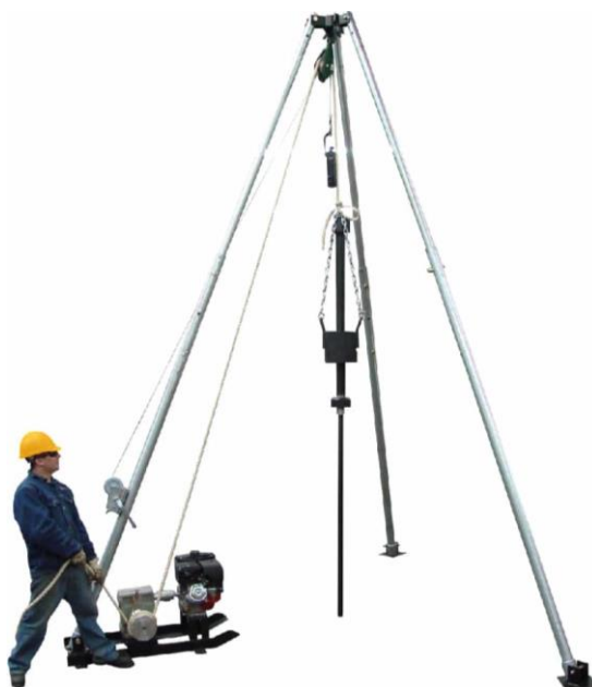
Ilustración 1. Esquema típico del SPT
